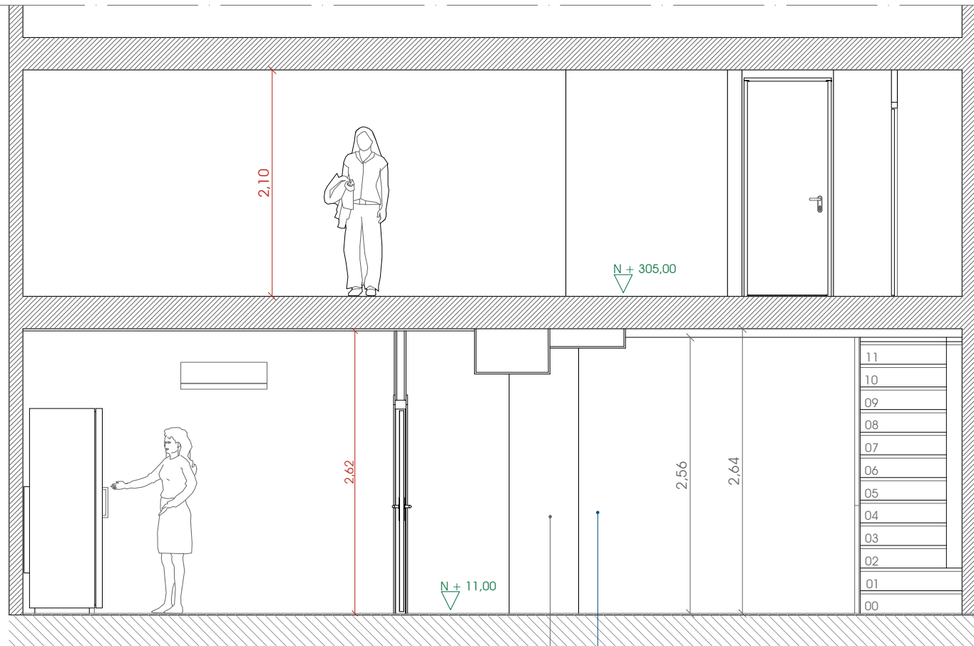
SECCIÓN BB TRASVERSAL EN ESTADO REFORMADO, E 1 / 50
