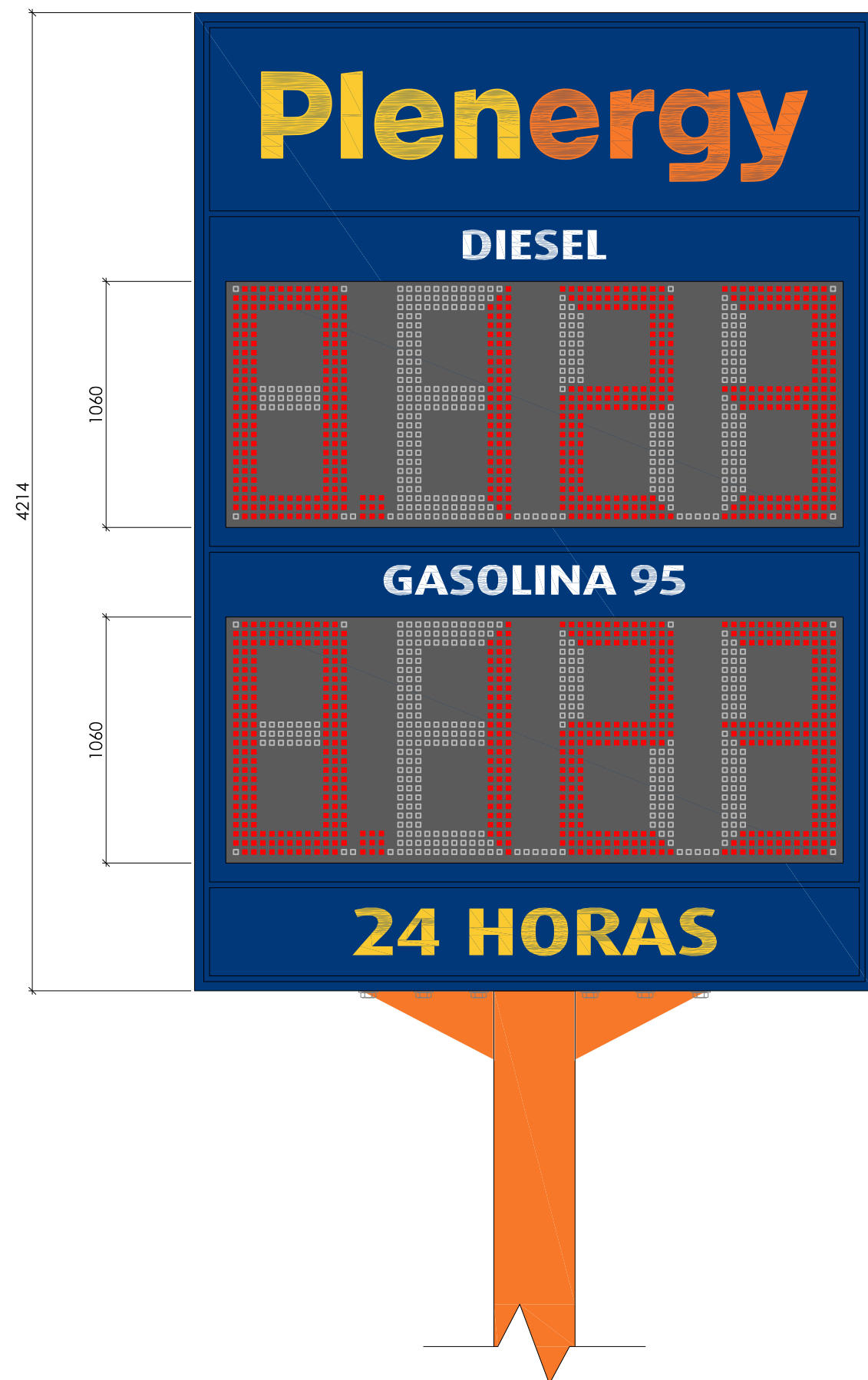
MÓDULO TÓTEM A UTILIZAR EN E.S. CABEZA DE TOTEM CON DÍGITOS DE 1000mm PARA FUSTE INFERIOR A 6,336m
